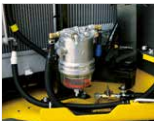
ウォーターセパレータ機能付燃料プレフィルタ
