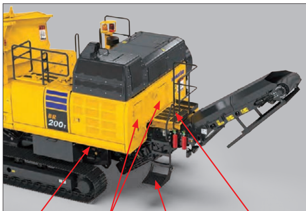
ダストシュート 清掃用ドア ステップ 清掃用プラットフォーム
