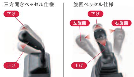
上げ・下げ等、荷台ロック解除スイッチを押しながら動かすと作動し、誤操作を防止します。
