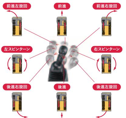
前後進と左右旋回、速度の調整が行え、2速増速スイッチで1速⇄2速の切り替え※も簡単にできます。
